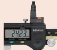
Pied à coulisse Absolute avec câble 02AZD790C
