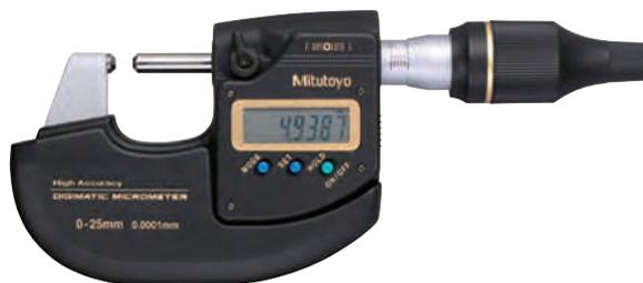
Micromètre haute précision avec coque de protection thermique (accessoire standard)
