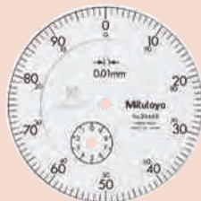
Cadran continu (Graduation bidirectionnelle)
