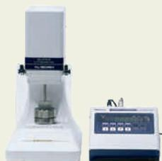
**Mesureur vertical à faible pression de mesure**
