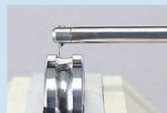
Profil intérieur/extérieur d'un roulement
