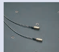
Sondes de température pour système de compensation thermique
