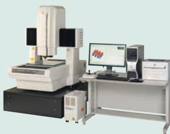
**Machine de mesure 3D CNC multi-capteurs**
