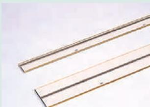
Règle en verre cristallisé de très grande précision, présentant une dilatation thermique quasi nulle. Quick Vision Ultra est équipée de règles en verre cristallisé d'une résolution de 0,01 µm présentant un coefficient de dilatation thermique de 0,08 x 10<sup>-6</sup>/K.
