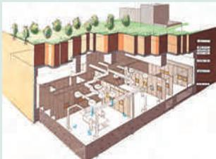
Usine de fabrication de règle de ultra-haute précision à 11 m sous terre (ex. : codeur linéaire).
